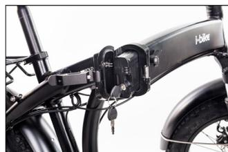
3. Utilizzare le chiavi in dotazione per sbloccare la batteria ed estrarla dal telaio
