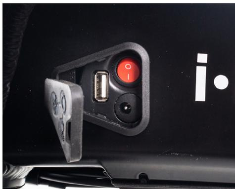
È possibile attivare o disattivare la centralina della bicicletta premendo il tasto rosso situato all'interno dell'alloggio nella parte centrale del telaio (vedi foto)
