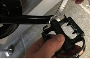
Una volta che si è fatta entrare la filettatura, prendere la chiave inglese 17 mm in dotazione e fissare bene il pedale alla pedivella. Ripetere l'operazione con il pedale mancante.
