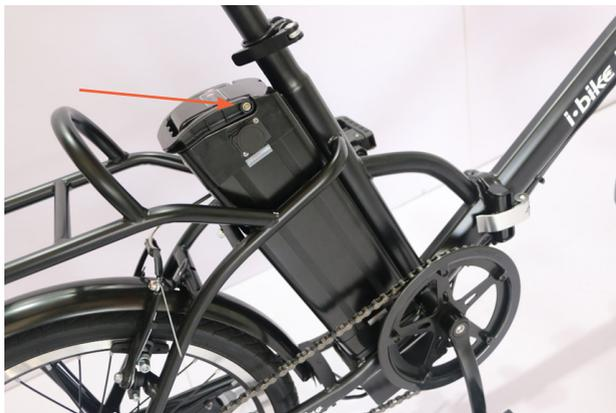
Durante la ricarica, l'indicatore del caricabatteria si illumina di rosso; al termine della carica l'indicatore diventa verde. Il tempo necessario per una ricarica completa è di circa 4 ore. Questo periodo può variare in funzione della carica residua.
